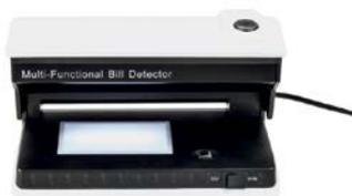
**Appareil d'expertise multifonctions** pour la détection des caractéristiques de sécurité de billets de banque, timbres, chèques, etc. Reconnaissance de fluorescence grâce à 2 x tubes UV 9W à lumière réfléchie. Détecteur de filigrane grâce à une lumière blanche par le bas. Détecteur magnétique avec signal optique et acoustique pour la détection de caractéristiques de sécurité magnétiques. Format: 230 x 145 x 125 mm / Alimentation secteur 220 V. LINS7084 **CHF 65.00**
