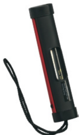
Lampe pour analyse de timbres phosphorescents , sans filtre verre quartz, à ondes courtes 4W/254nm, Format: 170x40x35 mm, avec piles.
